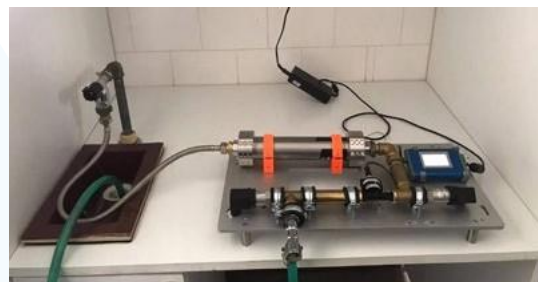
Un dispositivo desarrollado por investigadores para medir el efecto del agua tratada con IPS a diferentes presiones sobre el crecimiento, producción y calidad de las plantas.
